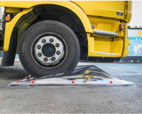
Test met Skylux pantserkoepel in polycarbonaat: de koepel breekt niet, maar plooit en springt uiteindelijk terug in zijn originele vorm
